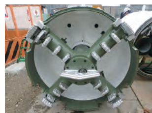
カッタヘッド状況
