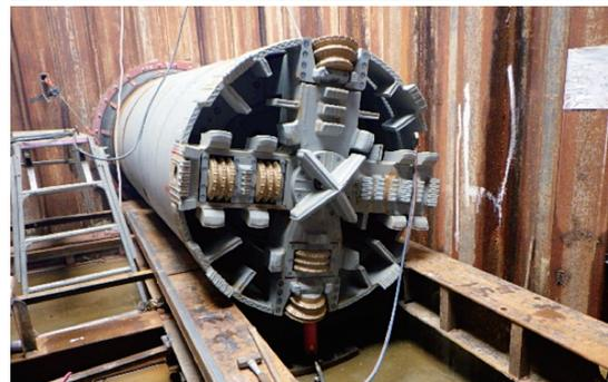
写真-4 上段発進時・下段ビット交換
