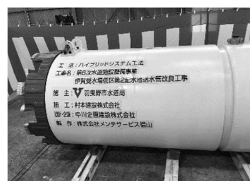
写真3 使用したシールドマシン
